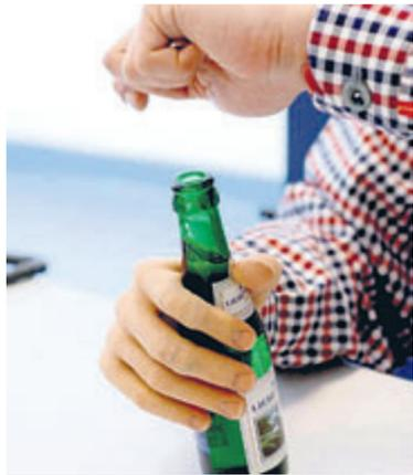
Die Fluidhand (unten) sieht täuschend echt aus, sie ermöglicht fünf Griffe. FOTO: FZK
