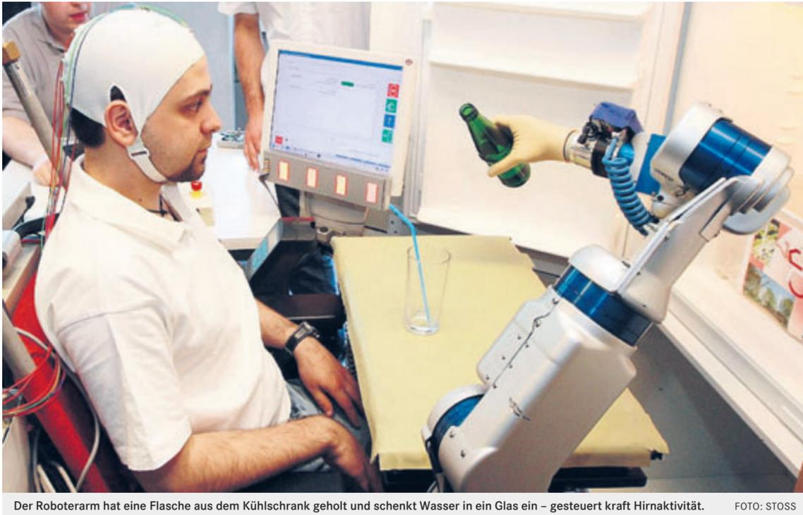
Der Roboterarm hat eine Flasche aus dem Kühlschrank geholt und schenkt Wasser in ein Glas ein – gesteuert kraft Hirnaktivität. FOTO: STOSS
